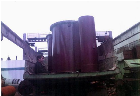
Гидродинамический фильтр для очистки сточных вод, тонкость очистки 0,05 мм
