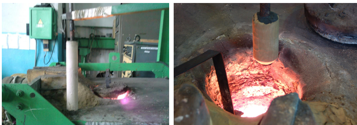
Рисунок 2 – Фото рудно-восстановительного блока для насыщения расплава марганцем и кремнием
